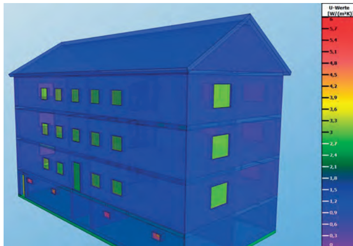
Zum Forschungsprojekt gehört die Ermittlung des Wärmedurchgangskoeffizienten der Häuser in der Alexander-Hess-Straße. Je höher dieser Wert, desto schlechter ist die Wärmedämmung.
